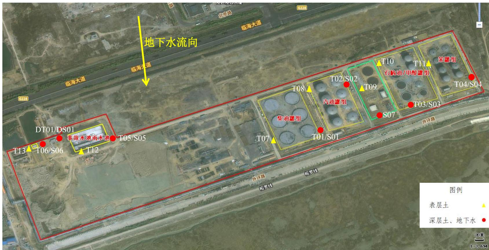
图 6.1-1 土壤和地下水监测点位布设图
